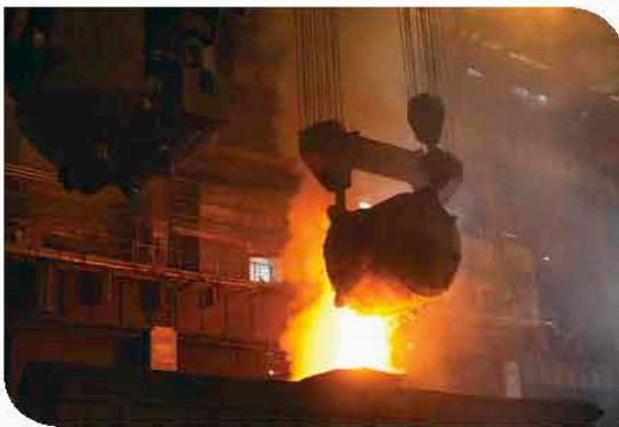
Figura 2.33. En la imagen se muestra el vaciado de hierro fundido sobre un molde. ¿De qué objeto a qué objeto u objetos se realiza la transferencia de energía térmica?
