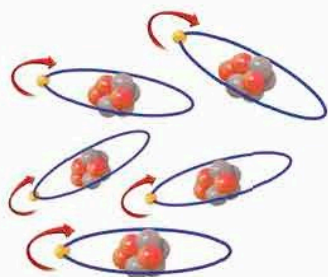
Figura 3.22. Los electrones que giran en un átomo generan una corriente eléctrica que, a su vez, genera un campo magnético.
