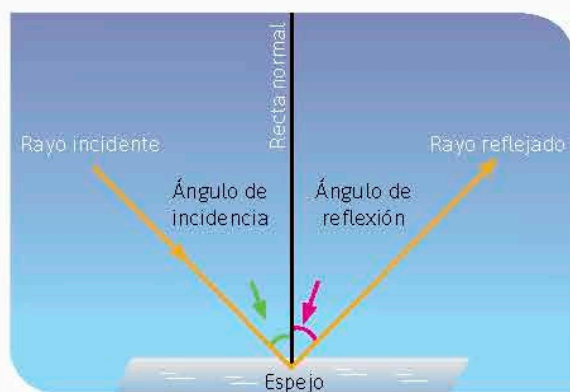
Figura 3.31. En el fenómeno de reflexión de la luz, el ángulo de incidencia es igual al ángulo de reflexión.
