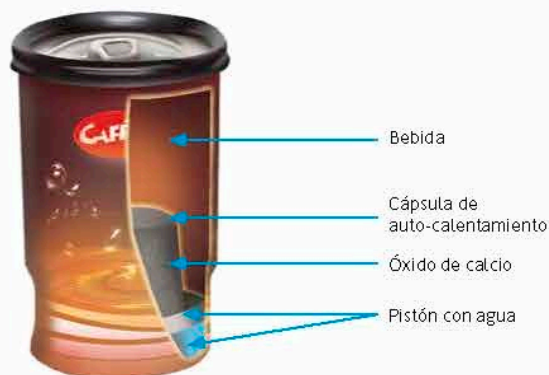
Figura 2.43. Los recipientes de autocalentado funcionan al romper un seguro y poner en contacto sustancias químicas, que al mezclarse producen una reacción exotérmica y liberan calor.
