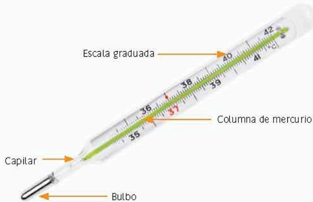
Figura 2.27. Partes de un termómetro de mercurio.
