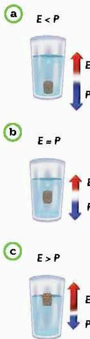
Figura 1.27. Cuerpo sumergido en un fluido. E es la fuerza de empuje y P representa su peso.
