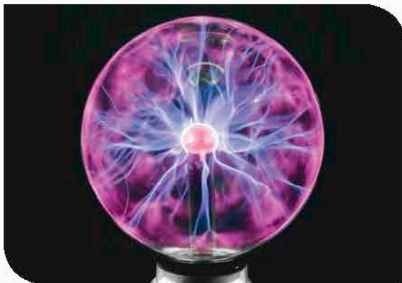
Figura 2.22 Las lámparas de plasma son un ejemplo de plasma generado artificialmente.
