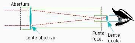
Figura 3.61. Esquema del telescopio de Galileo.
