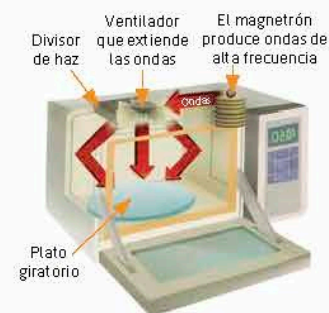
Figura 2.42. El magnetron emite un rayo de microondas, el ventilador reflejante hace rebotar ese rayo y el plato giratorio contribuye a que el rayo toque por igual todas las partes del alimento.
