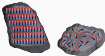
Figura 3.23. a) En algunos metales la magnetización puede ser permanente. b) Otros materiales no son magnéticos, pues no todos sus "imanes atómicos" están orientados en la misma dirección.
