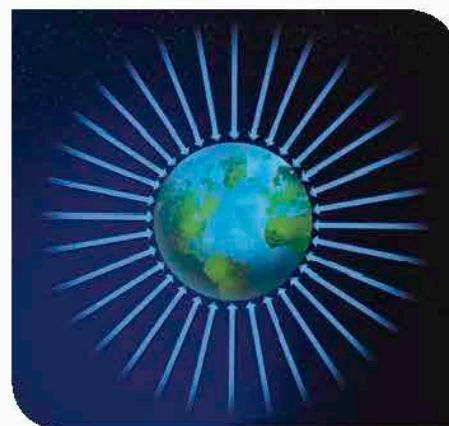
Figura 3.10. Representación del campo gravitatorio de la Tierra. Las líneas indican la dirección en la que actuaría la fuerza de gravedad sobre cualquier objeto a su alrededor.
